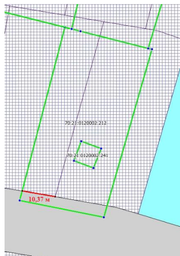
Рис. 5. Реестровая ошибка земельного участка 70:21:0120002:212
